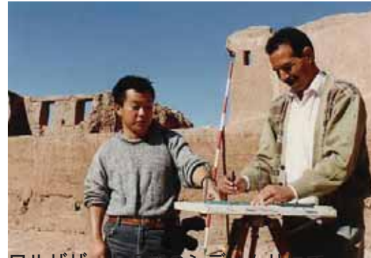
ワルザザット近郊のシディムサにて 平板測量を行う市川隊員。面積を広げなければ平板測量は現地 のスタッフでもマスターする。
